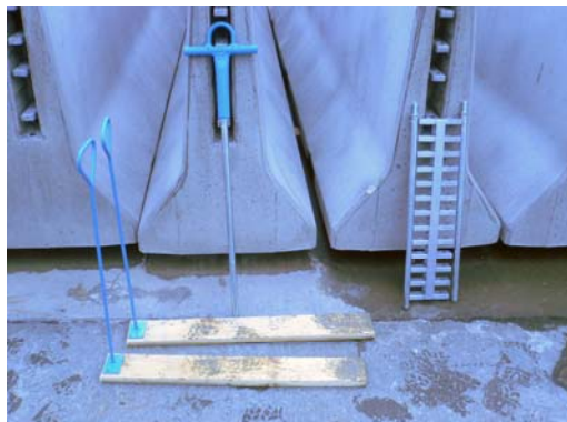
Pomocné prípravky a voľné ocel'ové súčasti zvodidla
